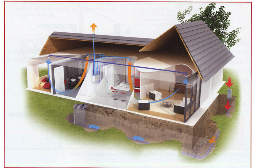
Schéma VMC double flux Duolix d'Atlantic (été)
